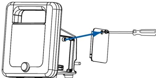
Pokud nebudeš instalovat žádný modul teploty, připoj standardní pravý panel přístroje pomocí křížového šroubováku. Tento panel bude při čelním pohledu na obrazovku na pravé straně.
