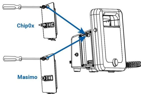
Chcete-li modul SpO<sub>2</sub> instalovat, připojte jej na levou stranu hlavní jednotky. Upevněte pomocí křížového šroubováku.
