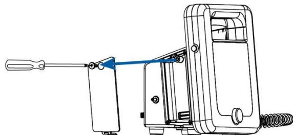
Odstraňte levý panel CT40 pomocí křížového šroubováku. Tento panel bude při čelním pohledu na obrazovku na levé straně.
