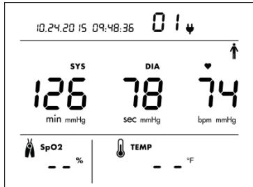
Zobrazení hodnot SYS, DIA a SF\* po měření TK v jednorázovém režimu.
