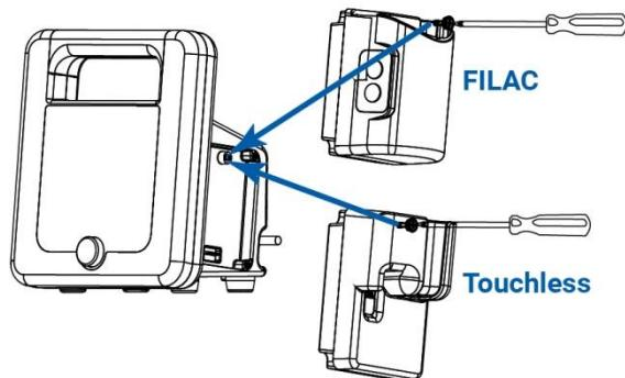
Chcete-li modul teploty instalovat, připojte jej na pravou stranu hlavní jednotky. Upevněte pomocí křížového šroubováku.
