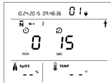
Vzhled obrazovky při nastavení průměrováho měření s výchozími hodnotami.
