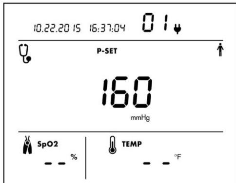
Vzhled obrazovky při nastavení auskultačního režimu. Třímístné číslo je nastavený cílový tlak v měřící manžetě. Výchozí hodnota je 160 mm Hg.
