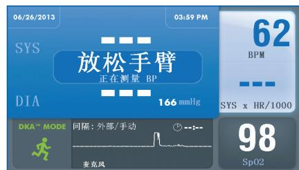
压力测试开始后，压力系统将提示监护仪开始采集血压读数。每次测量时，袖带将自动充气。同时显示一条消息“放松手臂，正在测量BP”，直到测量完成，之后将显示读数。您也可以按下START/STOP（开始/停止）按钮，手动地触发监护仪采集血压读数。此按钮也可用于在需要时退出读数。
