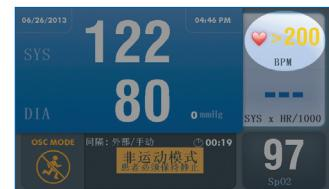
如果一个测量值超过了设定的警报值，则读数结束时，将发出5声蜂鸣声。引起警报的读数将会以黄色显示，同时在波形显示窗口中将给出黄色提示信息。
